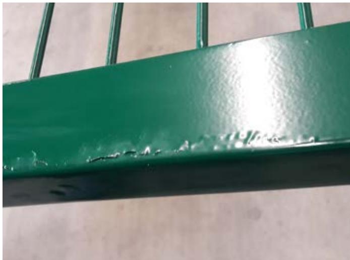
Abbildung 10: Zinkablösung nach der Beschichtung
