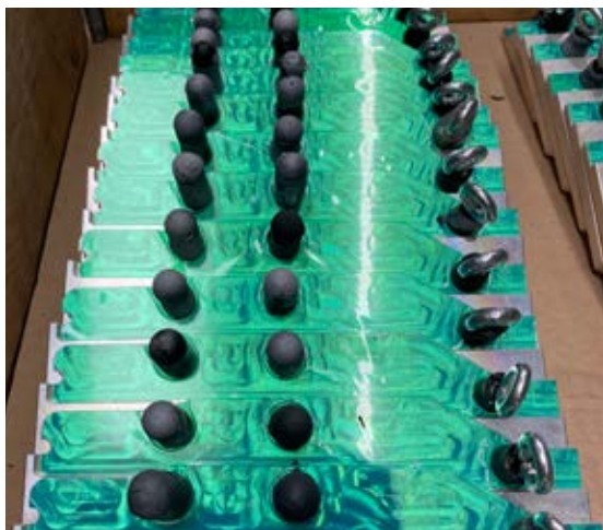
Abbildung 12: Maskierte Bauteile vor der Beschichtung
